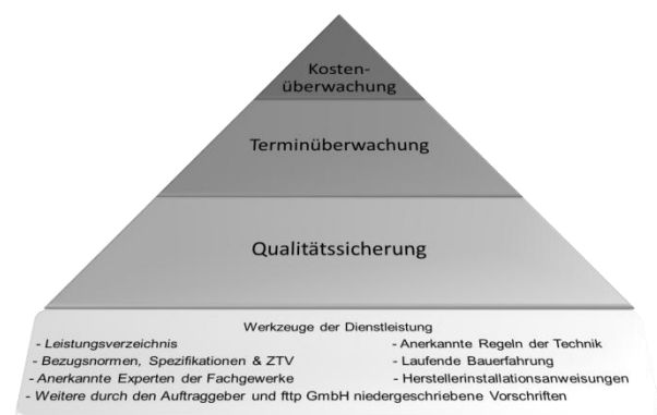
Abb. 1 Aufbau der Dienstleistungsebenen einer FTTx Projektüberwachung
