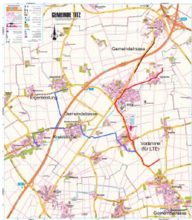
Abb. 5: Leerrohrnetz in Titz
